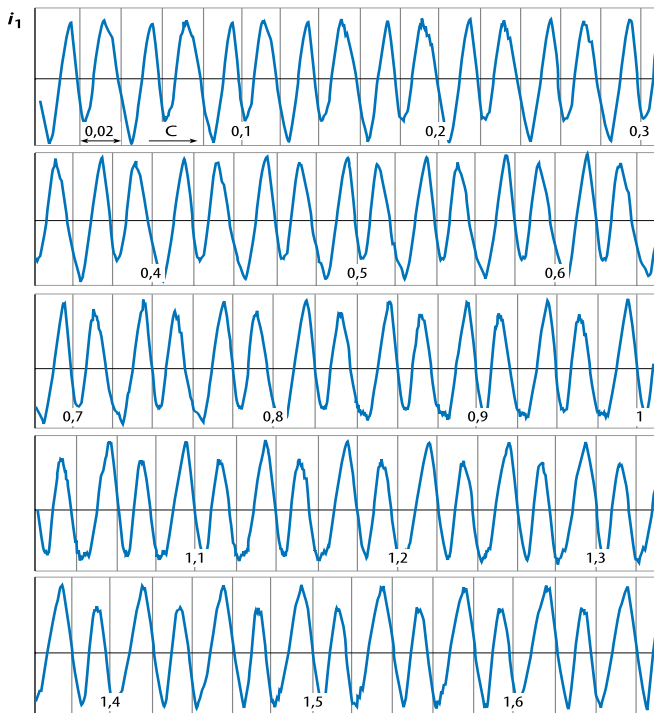
• Рис. 3. Осциллограмма тока статора при моделировании повреждений в механической части электродвигателя
